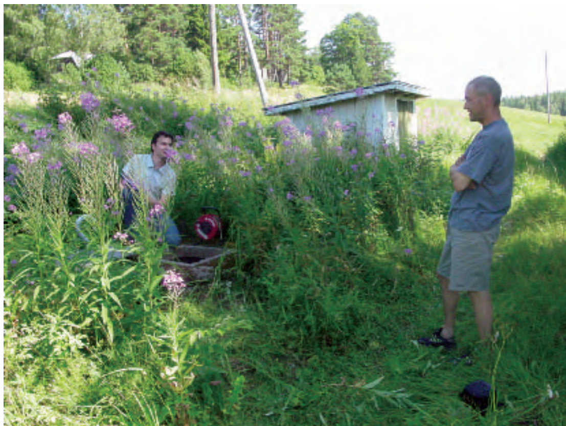
Kuva 4.1.1. Kaivokartoitusta Siuntiossa. Kaivokartoituksen tarkoituksena on määrittellä kaivon tekninen kunto sekä selvittää veden riittävyys ja laatu haastattelemalla kaivon omistajaa. Erityisesti koepumppauksen yhteydessä tehtävässä kaivokartoituksessa on tärkeää selvittää tutkimusalueella sijaitsevista kaivoista syvyys, vedenpinnan korkeus ja pumpun imuaukon korkeus ennen koepumppauksen aloittamista. Näin voidaan varautua koepumppauksen mahdollisesti aiheuttamiin muutoksiin. Kuva T. Kinnunen.
