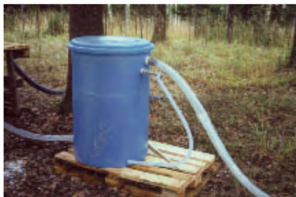
Kuva 6.7.1a. Kalkkikivisuodatuksen käsittelykokeissa käytetty pilot-laitos kentällä. Suodatin on täytetty kalsiittisella kalkkikivellä, jonka raekoko on 4 - 8 mm. Koe kannattaa tehdä pohjavesitutkimusten yhteydessä, mutta se on helppo tehdä myös käytössä olevilla laitoksilla. Kuvat M. Rontu ja E. Santala.
