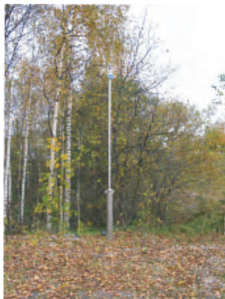
Kuva 4.1.3c. Vasemmalla: Havaintoputkeen asennetun automaattisen pohjaveden pinnankorkeusmittarin tietoja kerätään. Kuva T. Kinnunen. Oikealla: Automaattimittarilla ja GSM-lähettimellä varustettu havaintoputki. Havaintoputken tiedot voidaan kerätä reaaliaikaisesti matkapuhelinverkkoa hyväksikäyttäen vesilaitoksen valvomossa sijaitsevalle tietokoneelle. Kuva K. Vuorela.
