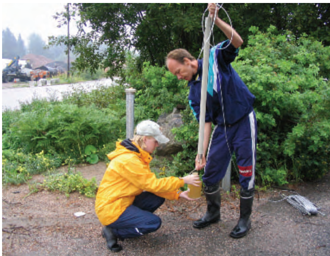
Kuva 6.2.1 c. Vähääntoisten ja matalien havaintoputkien tyhjentämisessä käytetään yleisesti bailer-tyyppistä putkinoudinta. Sillä voidaan nopeasti poistaa muutamia (kymmeniä) litroja vettä putkesta ilman monimutkaisia pumppausjärjestelyjä. Bailer on yleensä muovista valmistettu putki, jonka pohjassa on kuula- tai läppäventtiili. Bailer lasketaan narulla putkeen, jossa se painuu vedenpinnan alapuolelle. Kun vedellä täytynyt bailer nostetaan ylös vedestä, sulkeutuu pohjassa oleva venttiili ja estää bailerin tyhjentymisen, kun se nostetaan ylös putkesta. Kuvassa havaintoputkesta nostettua noudinta tyhjenetään näytepulloon. Kuva T. Penttinen.
