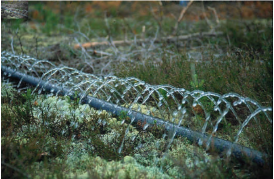
Kuva 4.1.5a. Tekopohjaveteen liittyviä imeytyskokeita sadettamalla. Kuva T. Hatva.
