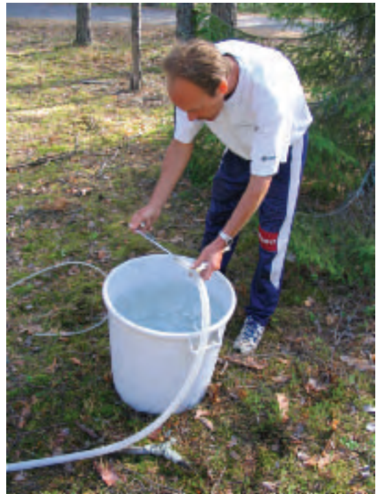
Kuva 6.4. Pohjaveden lämpötilan mittaus näytteenoton yhteydessä. Kuva T. Kinnunen
