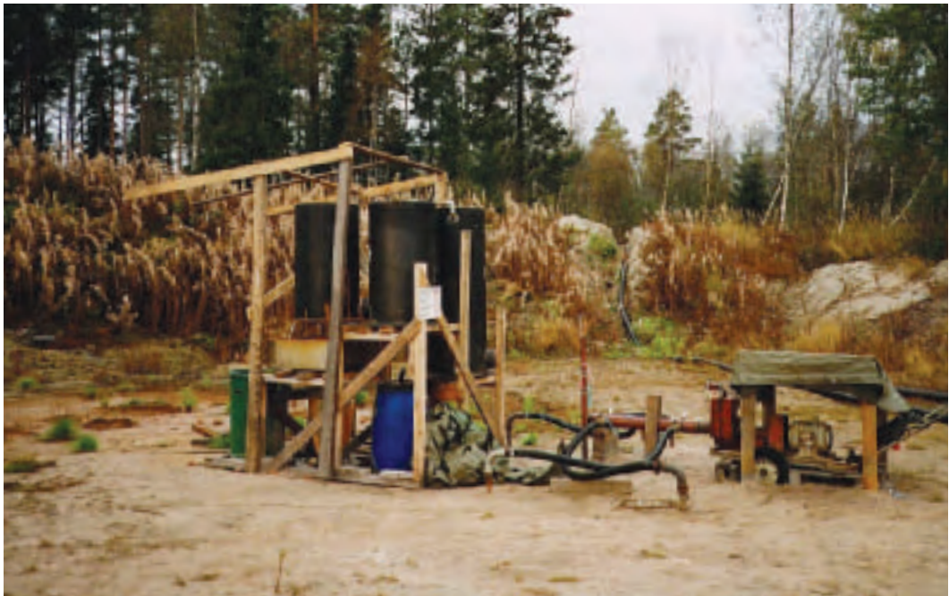
Kuva 6.7.1b. Raudan ja mangaanin poisto hidassuodatuksella. Sandnäsetin koelaitos Pedersöressä. Kuva J. Palomäki.
