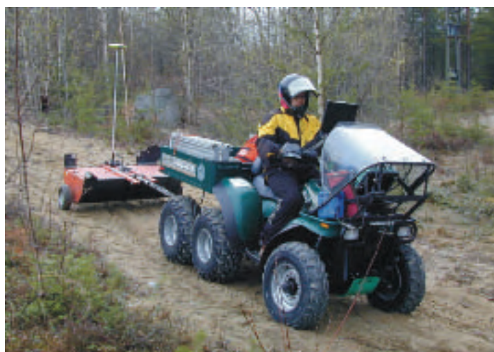
Kuva 5.2.4c. Mönkijään asennettu maatutkaluotauskalusto. Keskusyksikkö sijaitsee mittajaan edessä ja antenni mönkijän perässä. GPS antenni on sijoitettu antennin päälle reaaliaikaista xyz-paikannusta varten. Kuva O. Breilin.
