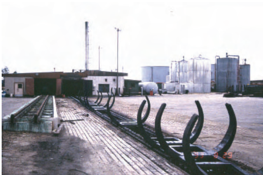
Kuva 4.3.4b. Suuri puunkyllästämö. Kyllästämöalueiden pohjaveden kromi- ja arseenipitoisuudet voivat olla korkeita. Kuva T. Hatva.
