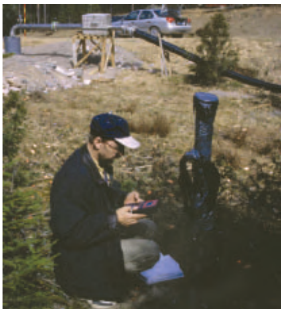
Kuva 4.1.3c. Vasemmalla: Havaintoputkeen asennetun automaattisen pohjaveden pinnankorkeusmittarin tietoja kerätään. Kuva T. Kinnunen. Oikealla: Automaattimittarilla ja GSM-lähettimellä varustettu havaintoputki. Havaintoputken tiedot voidaan kerätä reaaliaikaisesti matkapuhelinverkkoa hyväksikäyttäen vesilaitoksen valvomossa sijaitsevalle tietokoneelle. Kuva K. Vuorela.
