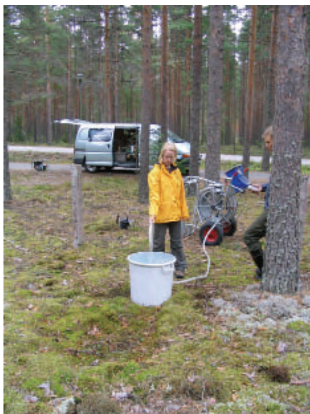
Kuva 6.2.3. Näytteenottopumppausta havaintoputkesta sähkökäyttöisellä uppopumpulla Nurmijärven Kiljavalla. Pumppauksen tuottoa mitataan astiamittauksella, samalla tarkkaillaan veden kirkastumista. Veden sameutta on helppoa arvioida vain, jos käytetty mitta-astia on vaalea. Suosittelavaa olisi käyttää kenttäkäyttöistä sameusmittaria. Pumpun tarvitsema sähköenergia tuotetaan bensiinikäyttöisellä aggregaatilla, joka pakokaasujen vaikutusten välttämiseksi on sijoitettu kauas varsinaisesta näytteenottopisteestä (auton vieressä takavasemmalla). Kuva T. Kinnunen.
