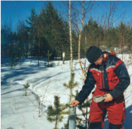
Kuva 4.3.6b Sähkönjohtavuuden mittausta kenttämittarilla. Kuva T. Nystén.
