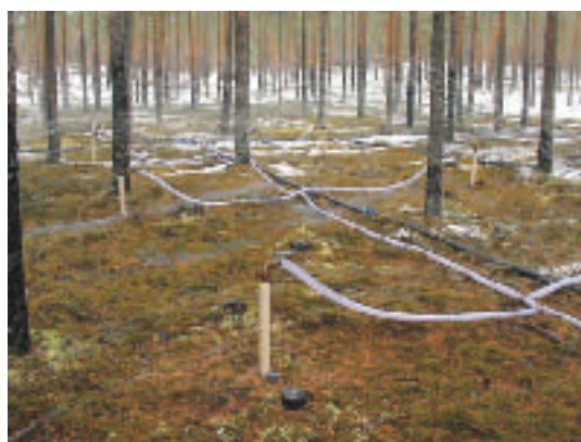
Kuva 5.3.3b. Merkkiaineen syöttöputkisto (vaaleat putket) sadetusimeytysalueella Alastaron Virttaankankaalla. Kuva J. Kääriä
