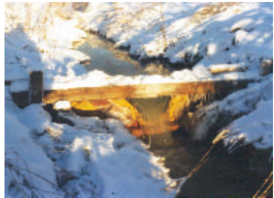
Kuva 5.2.3c. Kolmioaukkopato eli Thomson -pato koe-pumppauspaikan purkuojassa, Myrskylä. Kuva J. Hellgren.
